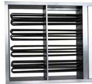
mit Kunststoffabdeckung. Die Weiterverdrahtung muss nach VDE 0100 erfolgen (gegen Aufpreis wird die Anschlussleitung in einen außerhalb des Gerätes liegenden Kunststoffklemmkasten geführt). Die Schaltung der elektrischen Gesamtanlage muss sicherstellen, dass das Elektroheizregister nicht ohne einen bewegten Luftstrom betrieben wird. Es ist ein zusätzlicher Sicherheitstemperaturbegrenzer mit Handrückstellung eingebaut.
