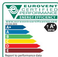
ganzheitlichen Betrachtung werden hierzu Kennwerte für Luftgeschwindigkeiten, externe Druckverluste, Auslegungs-Außentemperatur, Druckverluste der WRG, Wirkungsgrad der WRG und die elektrische Leistungsaufnahme der Ventilatoren gegeneinander zu einem einzigen Vergleichswert verrechnet, und das Gerät damit in die passende Energieeffizienzklasse eingestuft.
