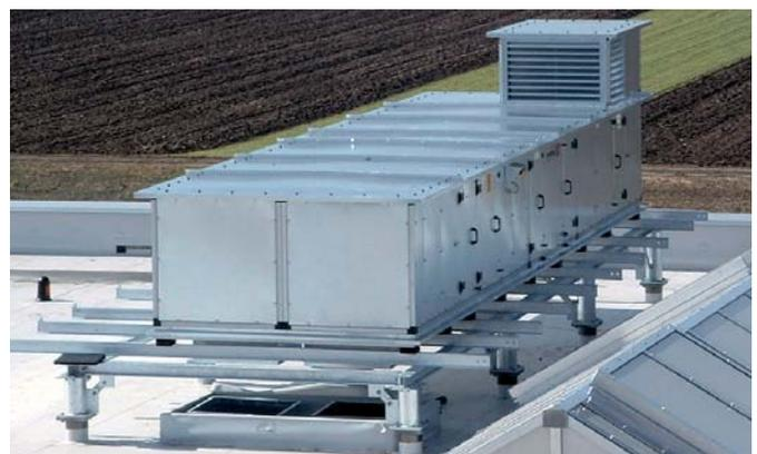
Das Gerätegehäuse selbst kann wie bei Geräten zur Innenaufstellung prinzipiell auch in allen verfügbaren Materialvarianten geliefert werden. Wir empfehlen für einen erhöhten Korrosionsschutz der Geräteaußenhaut mindestens in RAL 7035 bandbeschichtetes verzinktes Stahlblech sowie die Beschichtung des Geräterahmens im gleichen Farbton im Fall der Bauweisen Airbox S40 / S60 / T60.
